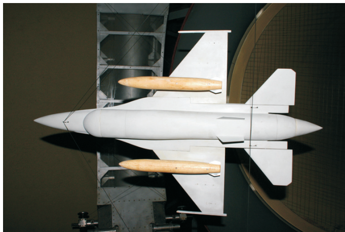
Fot. 7. Model samolotu z dwoma zbiornikami paliwa
