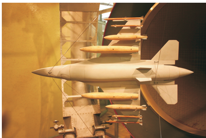
Fot. 10. Model samolotu z modelami: rakiet AIM-120, AIM-9, bomb i podwieszanych zbiorników paliwa
