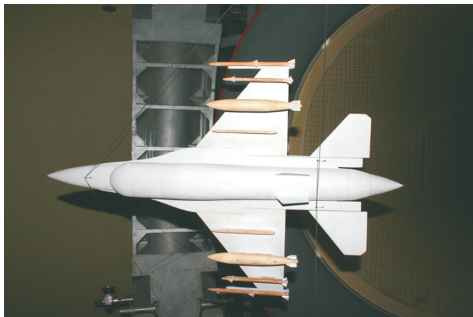
Fot. 9. Model samolotu z modelami: rakiet AIM-120, AIM-9 i bombami
