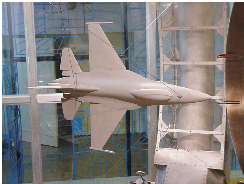
Fot. 1. Model samolotu w konfiguracji gładkiej, zawieszony w tunelu
