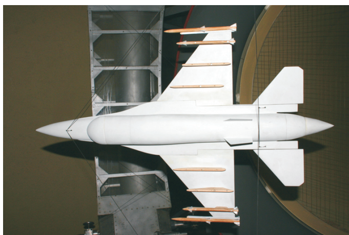
Fot. 8. Model samolotu z modelami rakiet AIM-120 i AIM-9
