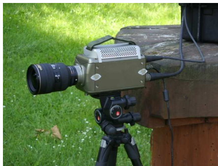
Rys. 4. Kamera do zdjęć szybkich Phantom v7.3 na stanowisku badawczym podczas rejestracji zjawiska rykoszetowania pocisków
