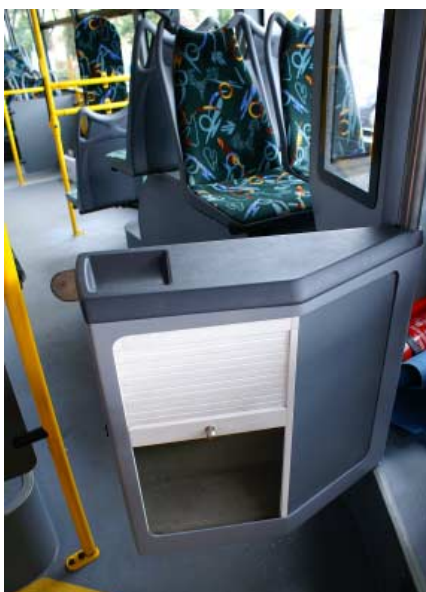
W drzwiach kabiny kierowcy zabudowano zamykany schowek na osobiste rzeczy prowadzącego pojazd
