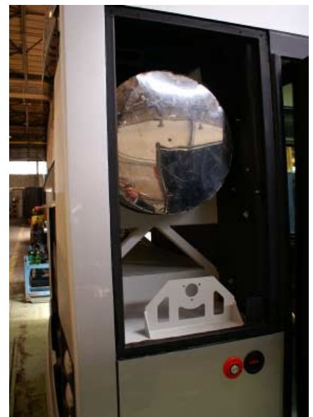
Kriogeniczny zbiornik w Solcity SM12 przystosowanym do zasilania LNG
