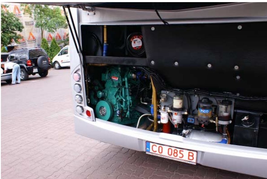
Podstawową jednostką napędową jest silnik Cummins ISBe5 o mocy 184 kW (250 KM). Po prawej strony widoczny jest zbiornik płynu AdBlue
