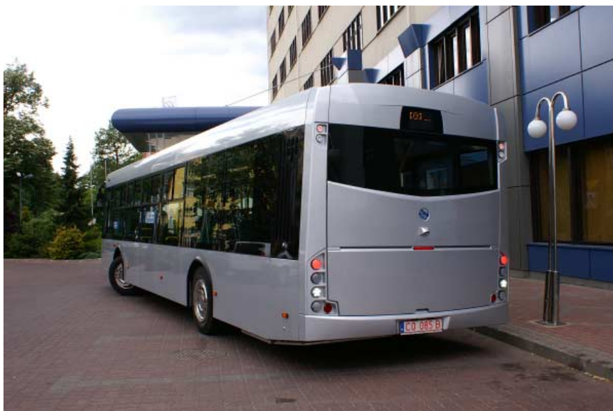
Ściana tylna, z charakterystyczną szybą i z zamontowaną centralnie kamerą cofania
