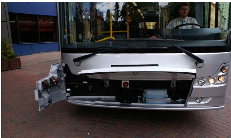
Ściana przednia Solcity SM12 z otwartymi pokrywami przeglądowymi
