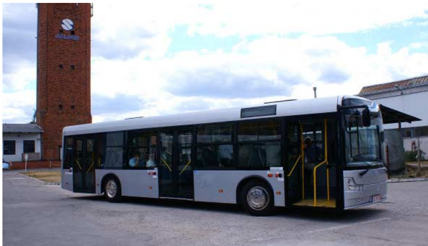
Solbus Solcity SM12 na terenie fabryki w Solcu Kujawskim. Nadwozie wyróżnia się zastosowaniem okien bocznych z dużymi przesuwными szybami
