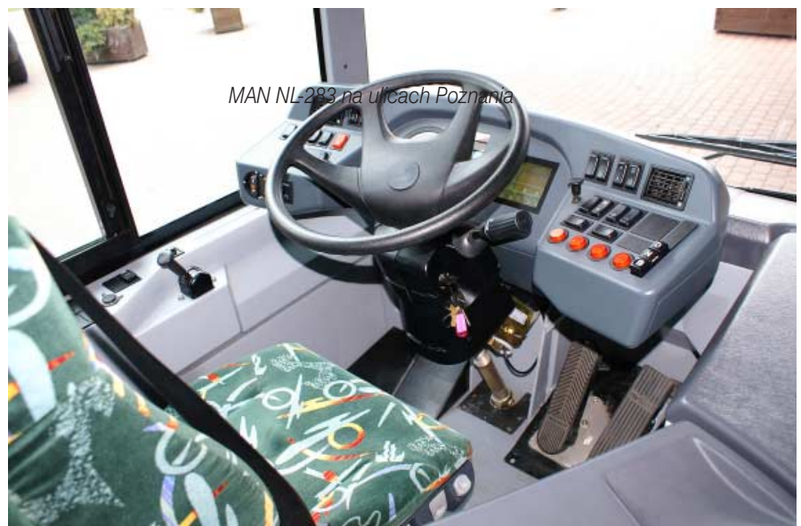
MAN NL-283 na ulicach Poznania Stanowisko kierowcy wyposażono w deskę typu FAP
