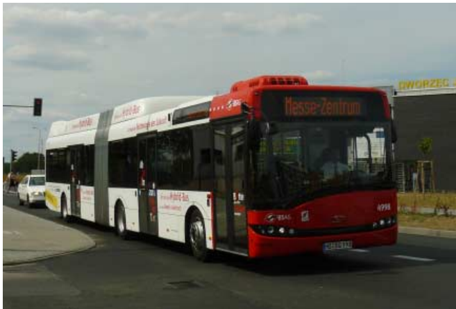
Autobus hybrydowy drugiej generacji podczas prób eksploatacyjnych na ulicach Poznania. Na dachu z przodu widoczny układ chłodzenia baterii NiMH
