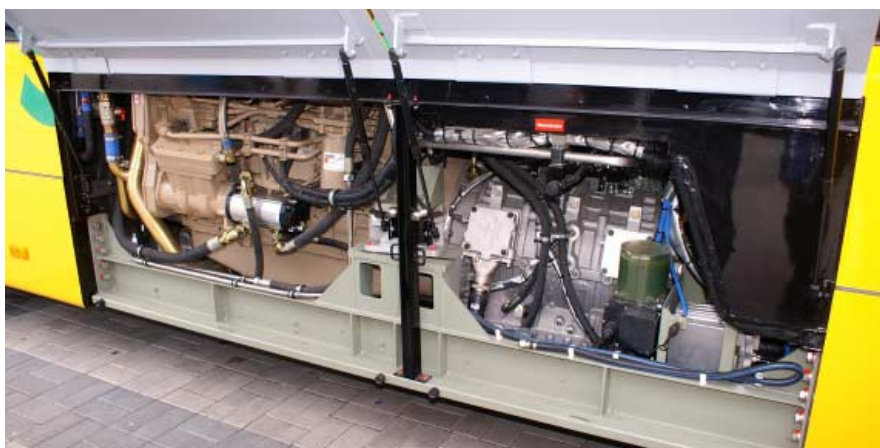
Silnik wraz z hybrydowym napędem EV Drive zabudowano pomiędzy osiami pierwszego członu
