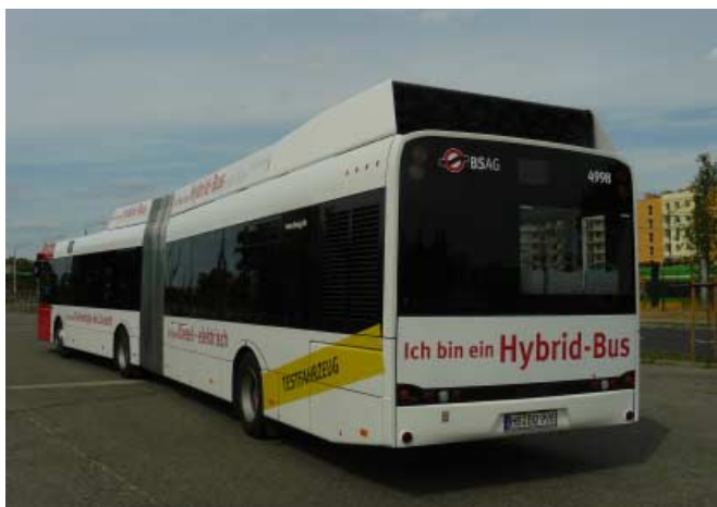
Dzięki kompaktowym rozmiarom, układ napędowy przeniesiono na zwis tylny, tak jak w konwencjonalnym autobusie przegubowym
