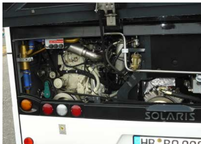
Pierwotnym źródłem energii jest silnik spalinowy Cummins ISBe4 o pojemności 6,7 dm 3
