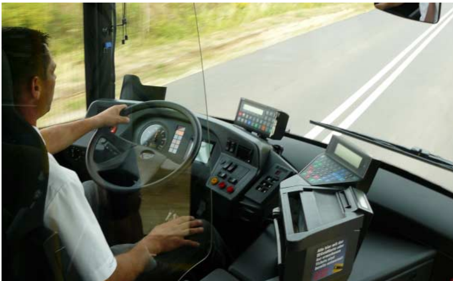
Na stanowisku kierowcy jedynie mała przystawka zamontowana po prawej stronie deski rozdzielczej zdradza, że mamy do czynienia z autobusem hybrydowym
