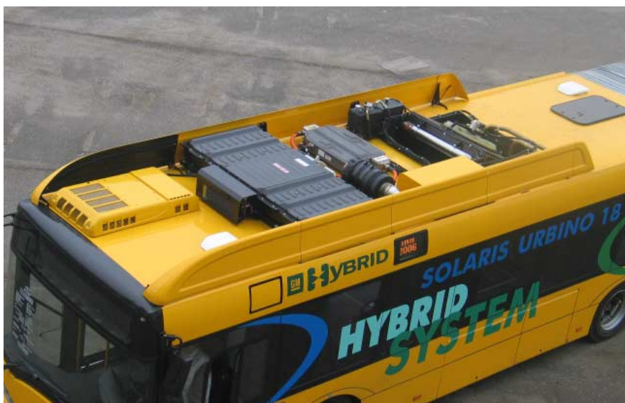
Bateria i moduł sterowania mocą wraz z układem chłodzenia na dachu przedniego członu autobusu pierwszej generacji
