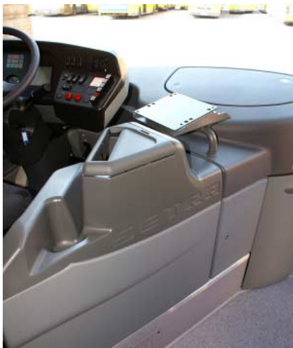
Fot. 11. W drzwiach kabiny zamontowano moduł do przyjmowania i wydawania reszty
