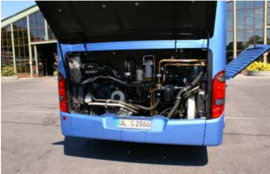
Fot. 14. Standardowe źródło napędu stanowi dwunastolitrowy silnik OM457 LA
