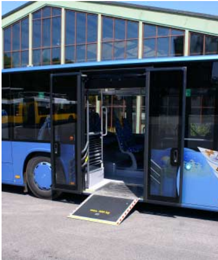
Fot. 6. Wjazd wózka inwalidzkiego do autobusu umożliwia ręcznie rozkładana rampa
