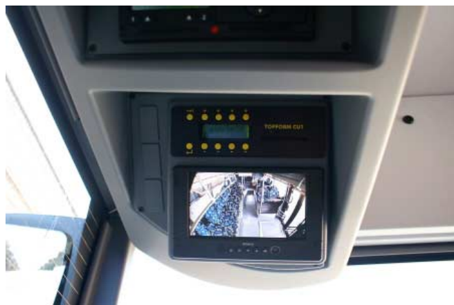
Fot. 13. Monitor umożliwiający podgląd wnętrza
