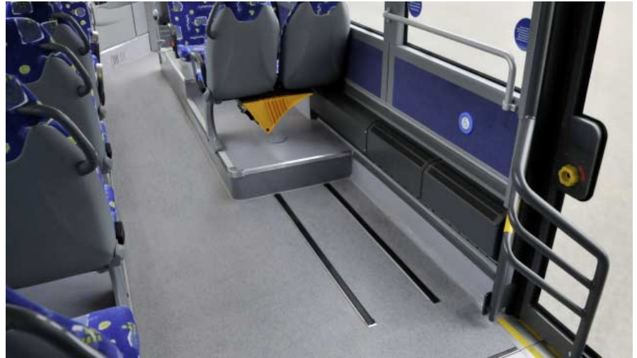
Fot. 9. Stanowisko do mocowania wózków inwalidzkich
