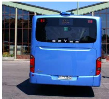
Ściana tylna. Wysoko poprowadzona górna linia pokrywy ułatwia dostęp do silnika. Jednym z elementów wyposażenia jest kamera cofania
