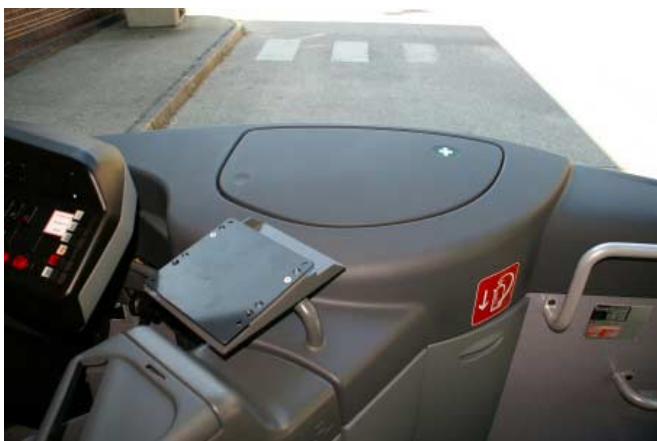
Schówek na apteczkę umieszczony w pasie podokiennym
