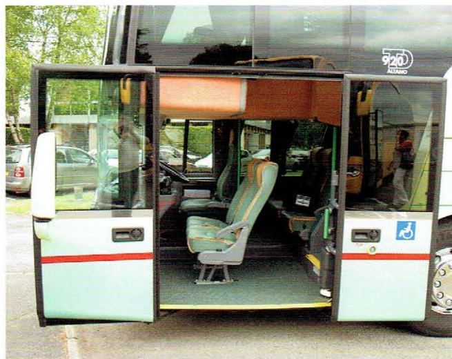
Standardowa aranżacja przestrzeni wokół stanowiska kierowcy w Altano
