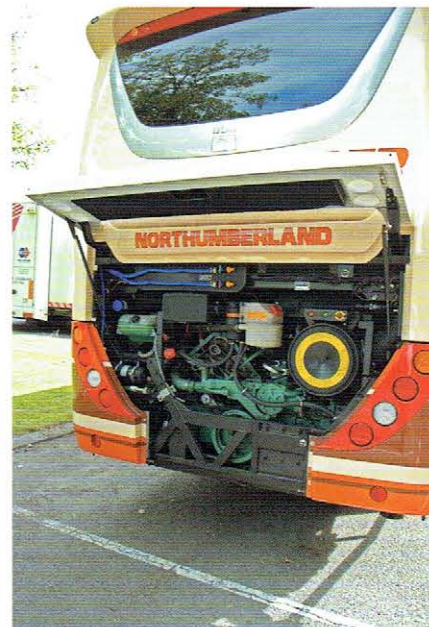
W Plaxtonie Elite pokrywą silnika podzielono na dwie niezależne części
