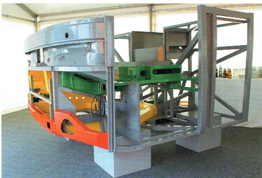
Elementy systemu FCG zabudowane w Mercedesie Travego. Na czerwono zaznaczono poprzeczną belkę zabezpieczającą samochody osobowe przed wjazdem pod autobus. Zielony element kratownicy to sztywna rama, do której przymocowany jest fotel kierowcy
