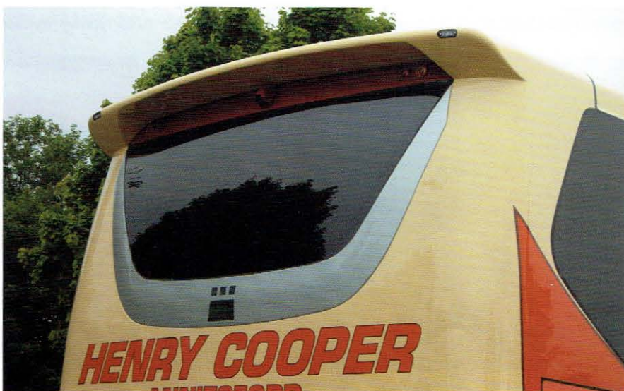
Tyłna część Plaxtona Elite z charakterystycznym spojlerem
