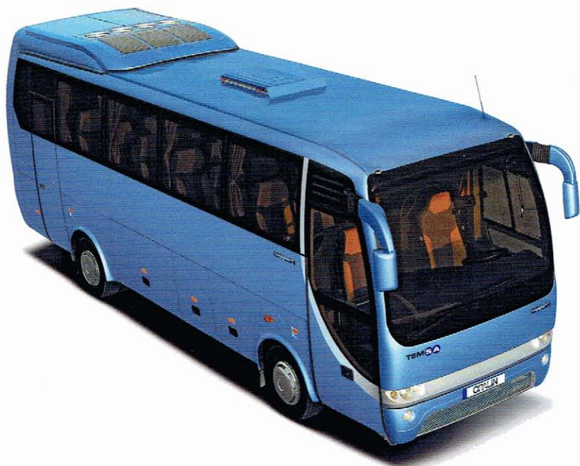
Dach autobusu ze zintegrowanym agregatem klimatyzacyjnym
