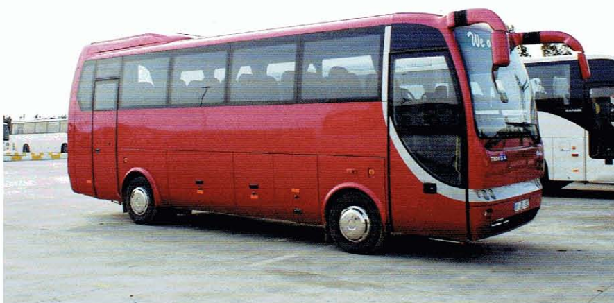
Opalin w wersji o długości 8,4 m przystosowany do przewozu 35 pasażerów
