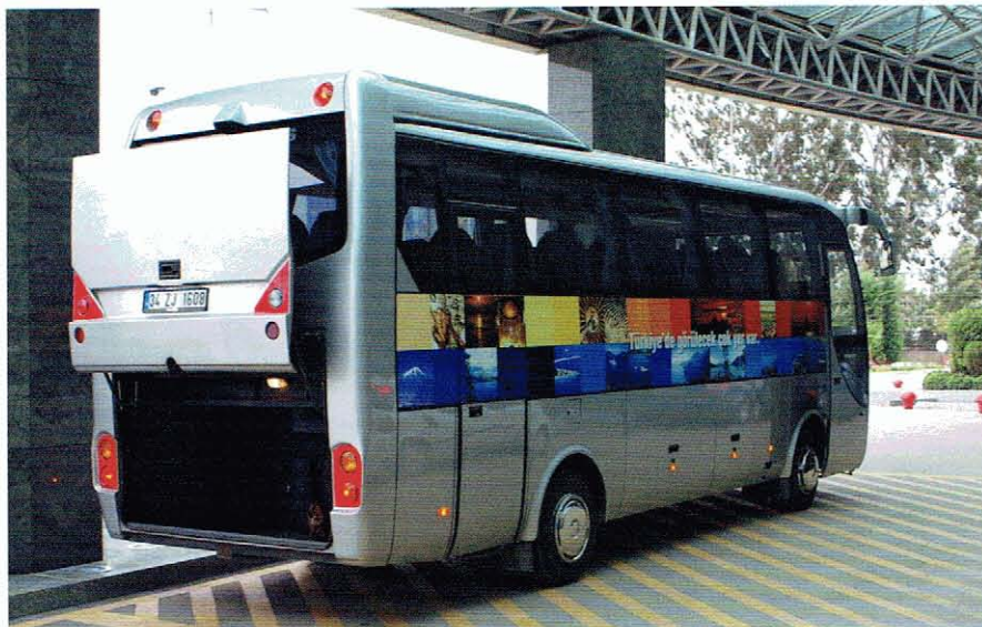
Główna przestrzeń bagażowa została zlokalizowana na zwisie tylnym
