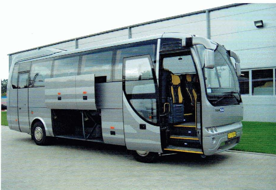
Pionowo otwierane pokrywy bagażników podpodłogowych
