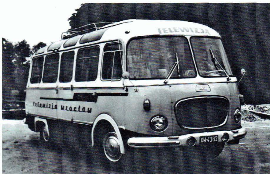
Autobus MAT Oławka wykorzystujący nadwozie przyczepy Jelcz P01
