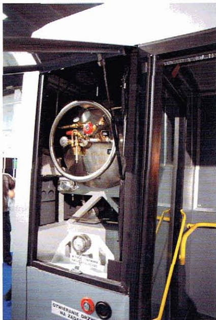
Instalacja LNG w Solcity SM12 podczas Transexpo w Kielcach
