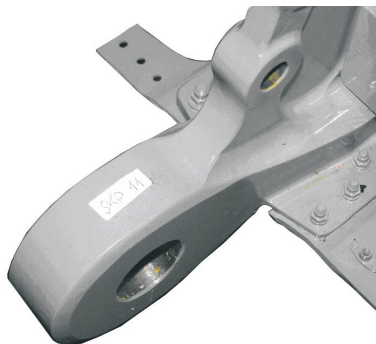
Rys. 1. Lokalizacja czujnika tensometrycznego na uchu węzła mocowania skrzydła (tensometr umieszczony był w miejscu etykiety z opisem pokazanej na rysunku)
