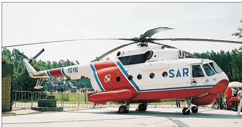
Rys. 2. Śmigłowiec morski (załoga: 4 osoby; długość: 25,31 m; szerokość: 3,8 m; wysokość: 5,32 m; masa: 11 750 kg; prędkość maksymalna: 230 km/h; pułap praktyczny: 3500 m)
