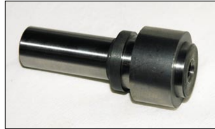
Rys. 6. Widok ogólny węzła tribologicznego łożysko-wałek
