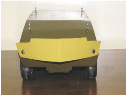
Rys. 6. Widok modelu redukcyjnego transportera z zamocowanym falochronem: a) widok z przodu; b) widok z boku
