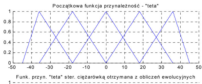
Rys. 12. Porównanie początkowej funkcji przynależności kąta położenia osi ciężarówka z funkcją przynależności uzyskaną za pomocą SE
