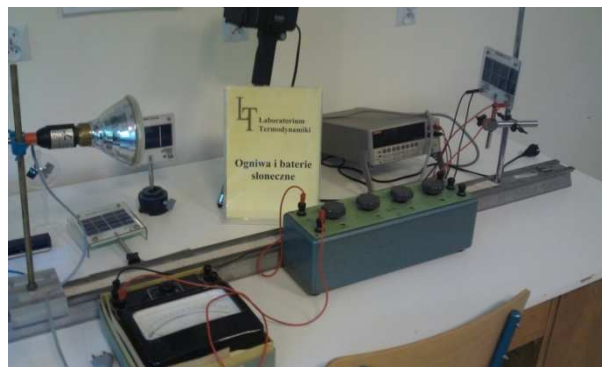
Rys. 19. Stanowiska laboratoryjne do badań ogniwa fotowoltaicznego i baterii słonecznych
