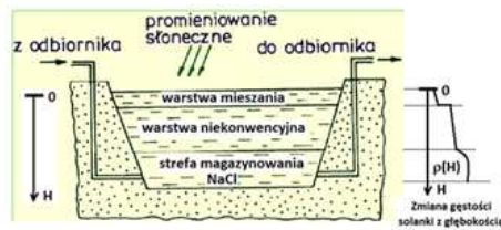
Rys. 14a. Schemat stawu słonecznego [13]
