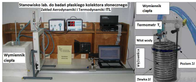
Rys. 12. Widok stanowiska laboratoryjnego do badań płaskiego kolektora słonecznego wraz z wymiennikiem ciepła
