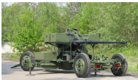
Rys. 2. Model laboratoryjny automatycznej armaty KDA 35 mm (RADWAR S.A.)
