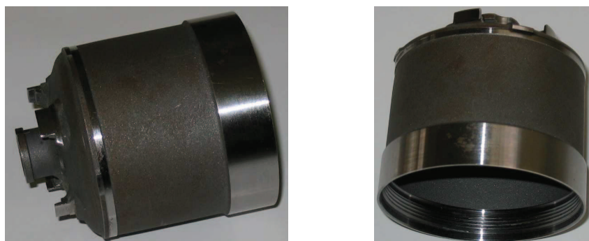
Rys. 1. Korpus silnika startowego ze stali „maraging” N18K9M5Ts z partii próbnej
