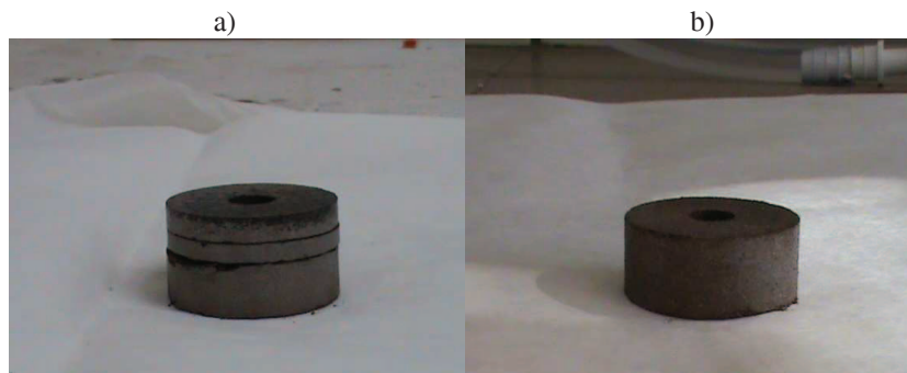
Rys. 5. Widok zaprasowanych kształtek ładunków termitowych: a) pastylka, która uległa rozwarstwieniu po wyjęciu z matrycy, b) prawidłowo zaprasowana pastylka ładunku termitowego
