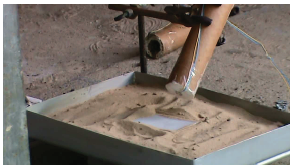
Rys. 4. Stanowisko do prowadzenia prób nad przepalaniem plastikowych osłon
