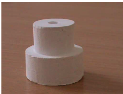
Rys. 3. Widok gipsowej dyszy wklejanej do obudowy palnika pirotechnicznego
