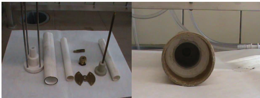
Rys. 2. Widok formy do formowania osłon palnika pirotechnicznego
