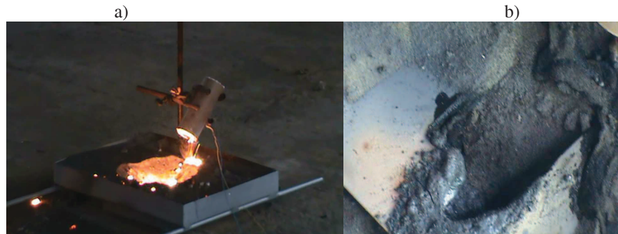
Rys. 7. Efekt działania palnika pirotechnicznego na: a) płytkę plastikową umieszczoną pod 5-centymetrową warstwą piasku, b) blachę stalową umieszczoną pod 5-centymetrową warstwą piasku
