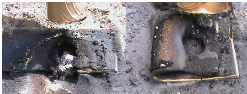
Rys. 6. Efekt działania palnika pirotechnicznego na płytki plastikowe umieszczone na powierzchni piasku
