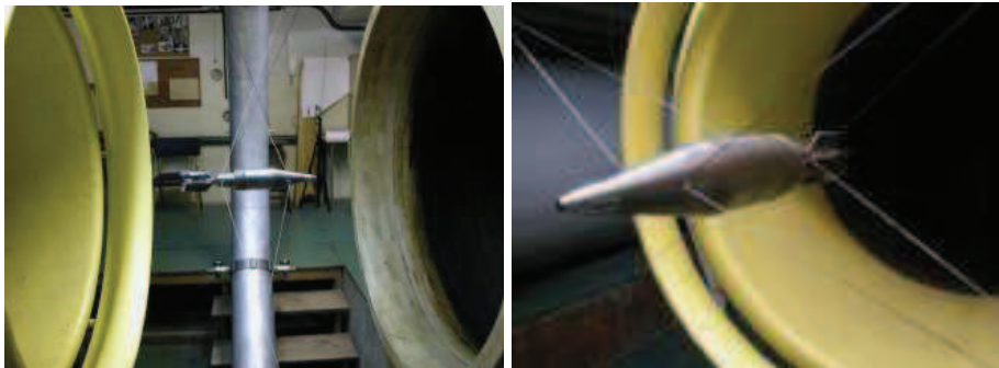
Rys. 4. Pocisk moździerzowy podczas badań w tunelu aerodynamicznym
