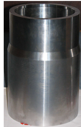
Rys. 7. Wsad przygotowany do zgniatania obrotowego na zimno
