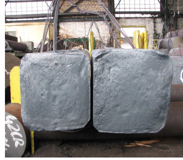
Rys. 1. Obraz kęsisk kutych na prasie na wymiar o przekroju kwadratowym 280x280 mm ze ściętymi narożami w celu uzyskania przekątnej 363 mm
