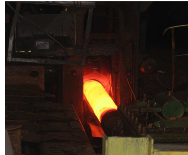
Rys. 3. „Szkłanka” w czasie walcowania w walcierce wydłużającej Fig. 3. A „bottle” during rolling in an elongating mill
