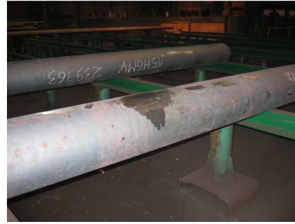
Rys. 5. Rury po walcowaniu na gorąco i ostudzeniu
