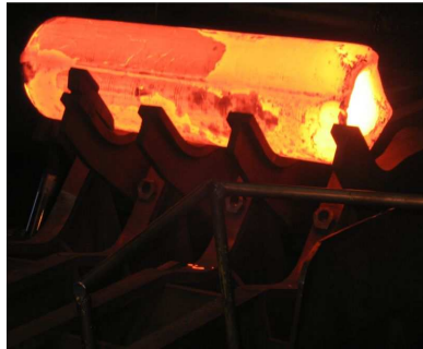
Rys. 2. „Szkłanka” po przebiciu dna Fig. 2. A „bottle” with a Pierce bottom
