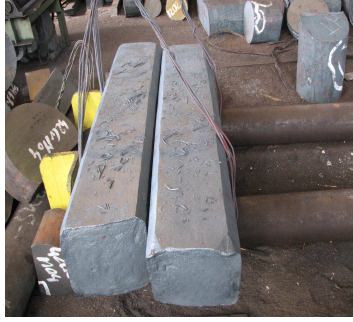
Rys. 1. Obraz kęsisk kutych na prasie na wymiar o przekroju kwadratowym 280x280 mm ze ściętymi narożami w celu uzyskania przekątnej 363 mm
