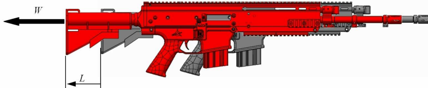
Rys. 1. Odrzut swobodny: W – prędkość odrzutu, L – droga odrzutu
