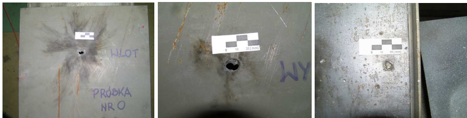
Fot. 2. Płyta nr 0 (od lewej): strona czołowa, strona tylna, płyta-świadek
