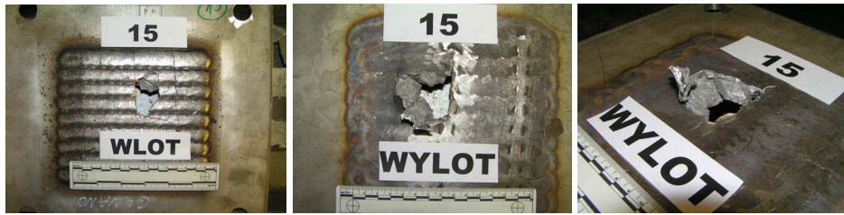
Fot. 18. Próbkę nr 15 (od lewej): strona czołowa, strona tylna, zbliżenie na wylot pocisku
