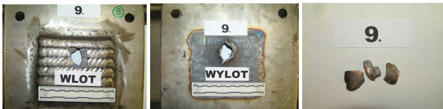
Fot. 17. Próbkę nr 9 (od lewej): strona czołowa, strona tylna, fragmenty warstwy napawanej płyty Photo 17. Specimen No. 9 (from the left): front side, back side, fragments of the hard coated layer of the plate
