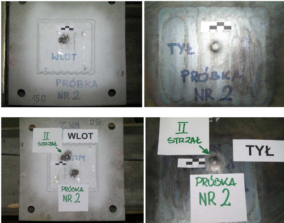
Fot. 3. Próbkę nr 2 (góra, od lewej): strona czołowa po pierwszym strzale, strona tylna po pierwszym strzale; (dół od lewej): strona czołowa po drugim strzale, strona tylna po drugim strzale
