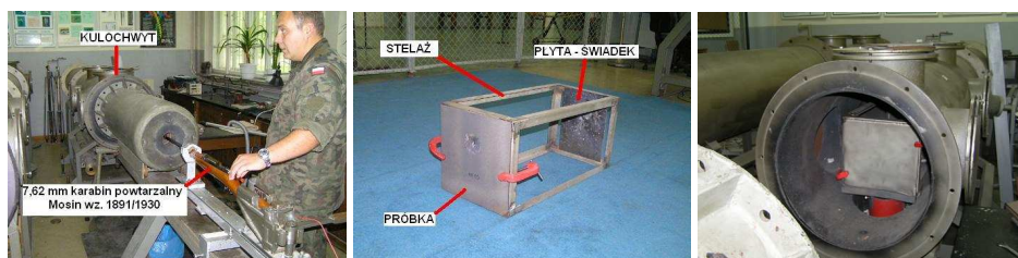
Fot. 1. Stanowisko badawcze z 7,62 mm karabinem powtarzalnym Mosin wz. 1891/1930 i dwuczęściowym kulochwytem (z lewej strony) oraz stelaż z zamocowaną próbką i płytą-świadkiem (w środku) przygotowany do umieszczenia w kulochwycie (z prawej strony)
