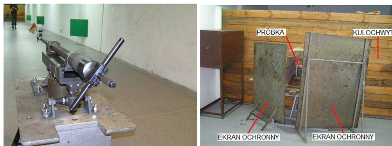
Fot. 10. Stanowisko badawcze (z lewej) oraz próbka zamocowana w stelażu otoczonym ekranami ochronnymi
