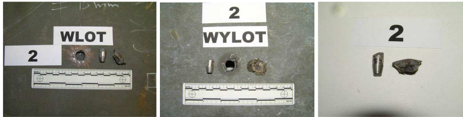
Fot. 11. Próbką nr 2 (od lewej): strona czołowa pierwszej płyty próbki, wylot pocisku w pierwszej płycie próbki, fragment rdzenia pocisku i korek wybity z pierwszej płyty próbki
