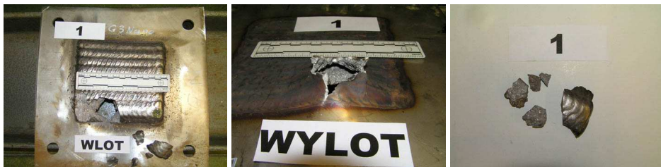
Fot. 19. Próbkę nr 1 (od lewej): strona czołowa, wylot pocisku oraz fragmenty napawanej warstwy płyty
