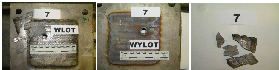
Fot. 20. Próbkę nr 7 (od lewej): strona czołowa, strona tylna, fragmenty warstwy napawanej płyty
