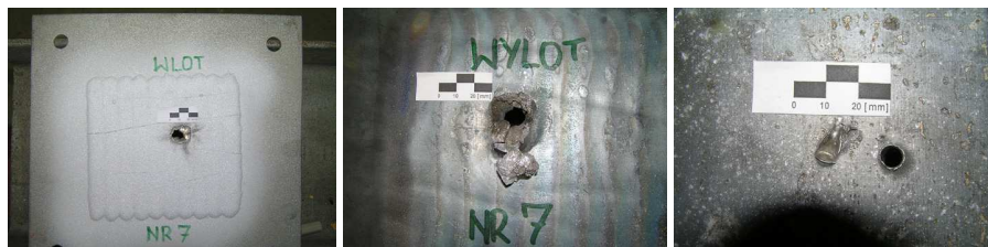
Fot. 6. Próbkę nr 7 (od lewej): strona czołowa, strona tylna, płyta-świadek
