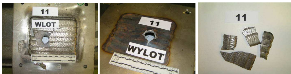
Fot. 21. Próbkę nr 11 (od lewej): strona czołowa, strona tylna, fragmenty warstwy napawanej płyty
