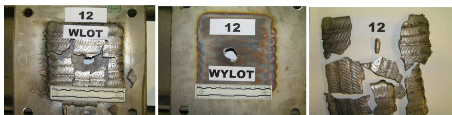
Fot. 22. Próbkę nr 12 (od lewej): strona czołowa, strona tylna, fragmenty warstwy napawanej płyty i rdzenia pocisku
