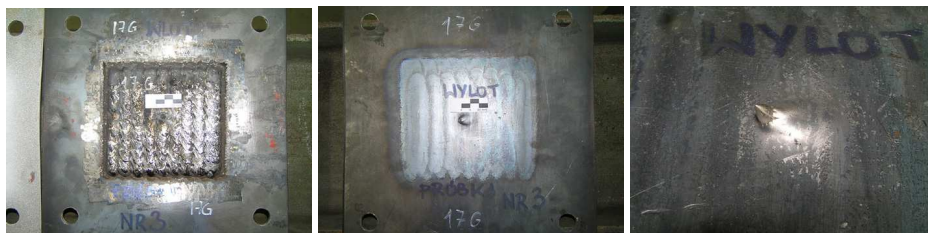
Fot. 4. Próbkę nr 3 (od lewej): strona czołowa, strona tylna, wierzchołek zatrzymanego pocisku w płycie
