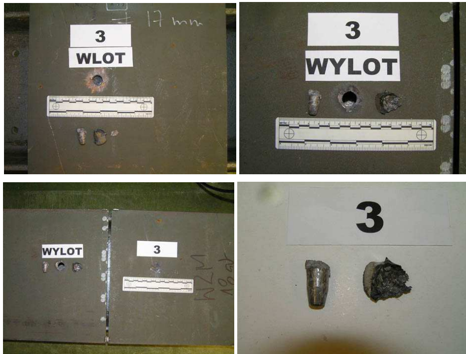
Fot. 12. Próbką nr 3 (górną, od lewej): strona czołowa pierwszej płyty próbki, wylot pocisku w pierwszej płycie próbki, (dolną, od lewej): pierwsza i druga płyta po uderzeniu pocisku oraz fragment rdzenia pocisku i korek wybity z pierwszej płyty próbki
