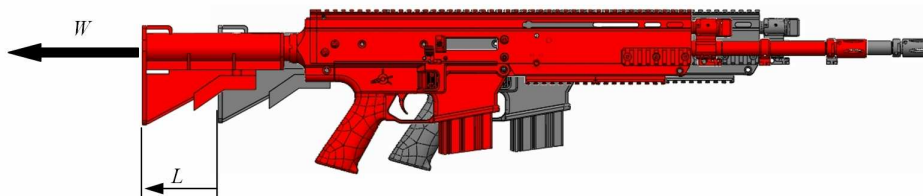
Rys. 1. Odrzut broni w czasie strzału: L – droga odrzutu, W – prędkość odrzutu
