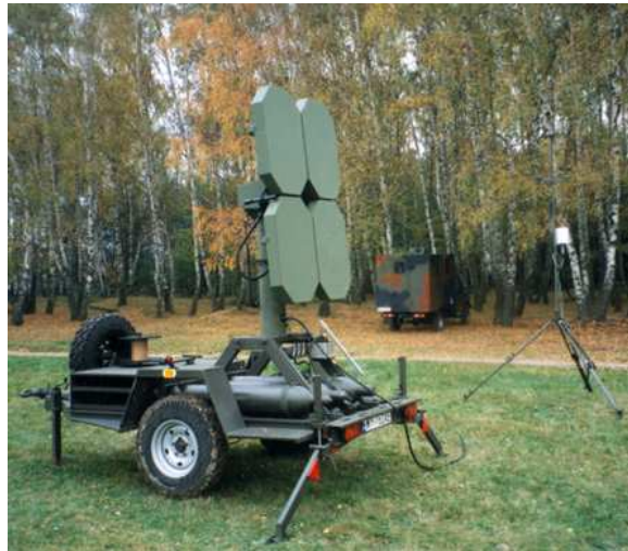
Rys. 5. Radioteodolitowy system sondażowy BAR [5]
