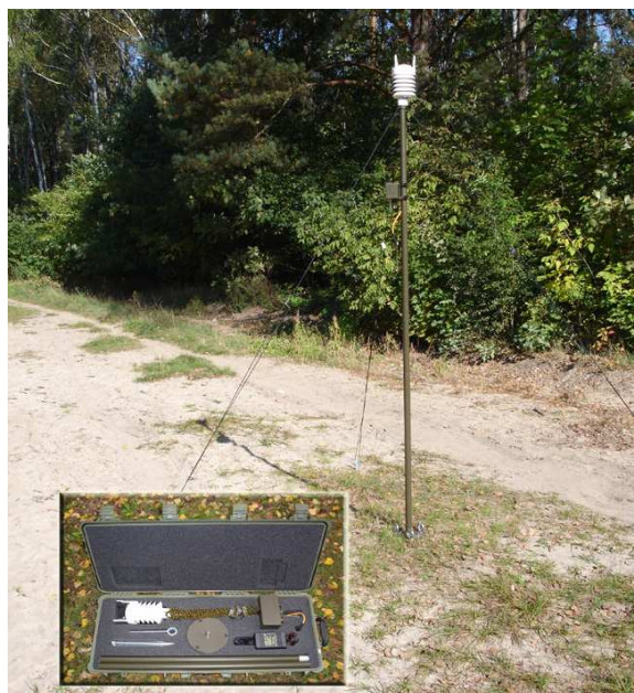
Rys. 4. Mobilny system do pomiarów meteorologicznych AGAT 30 [3]
