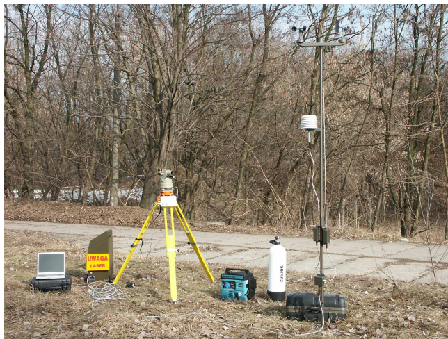
Rys. 3. Mobilny system meteorologicznych pomiarów pionowego profilu wiatru AGAT 20S [2]
