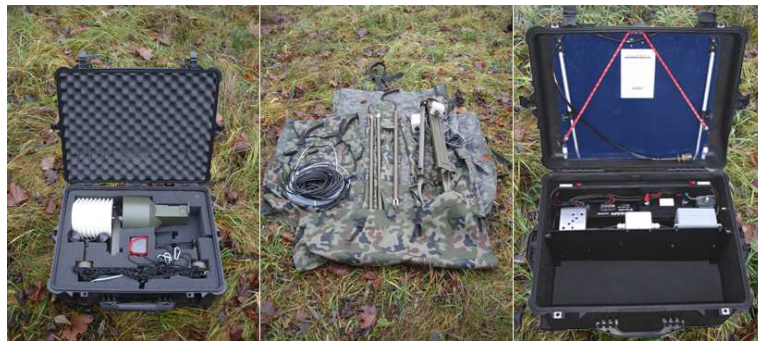
Rys. 2. Mobilny system do pomiarów meteorologicznych AGAT 20L [1]
