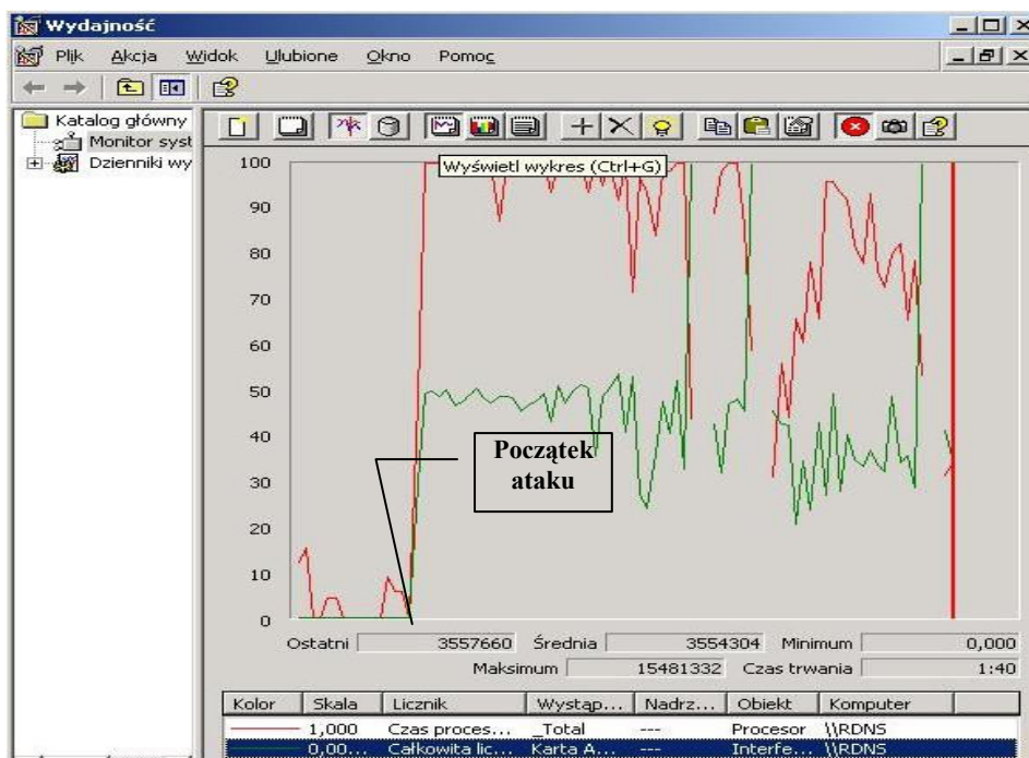
Rys. 20. Obciążenie procesora i karty sieciowej przed i podczas ataku UDPFlood
