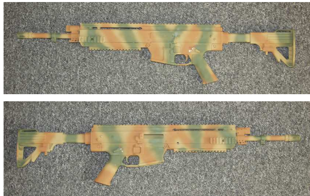
Fot. 3. Druga makieta demonstratora technologii karabinka standardowego zbudowanego w kolbowym układzie konstrukcyjnym, bez magazynka (sierpień 2009 r.)
