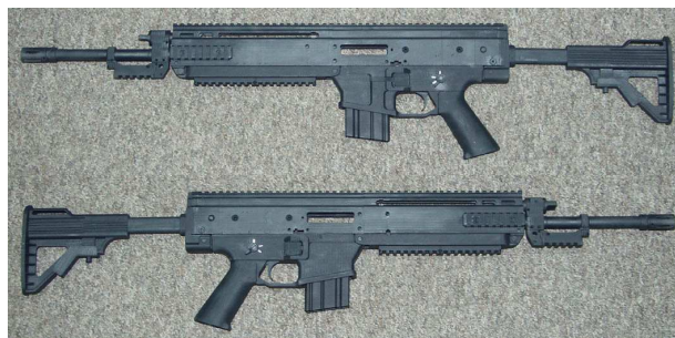
Fot. 1. Pierwsza makietka demonstratora technologii karabinka zbudowanego w klasycznym układzie konstrukcyjnym (grudzień 2008 r.)
