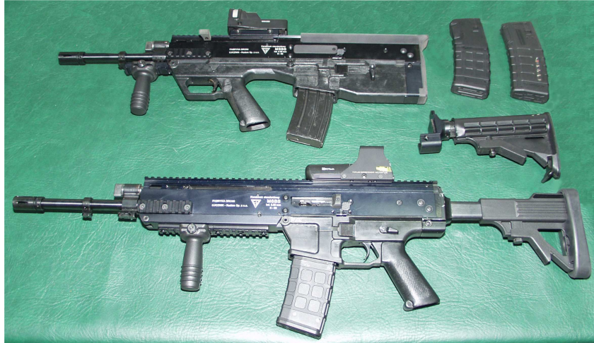
Fot. 7. Modele badawcze demonstratorów technologii karabinków: bezkolbowego (góra) i kolbowego (dół) wraz z kolbą i magazynkami dodatkowymi
