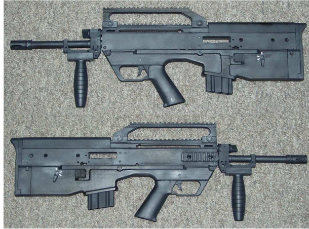
Fot. 2. Pierwsza makieta demonstratora technologii karabinka zbudowanego w bezkolbowym układzie konstrukcyjnym (grudzień 2008 r.)
