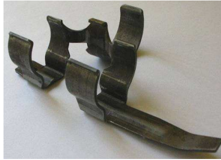
Rys. 4. Widok gotowego ogniwa taśmy do 30 mm naboju po operacjach obróbki plastycznej na zimno
