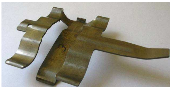
Rys. 2. Fotografia ogniwa po pierwszych trzech operacjach gięcia
