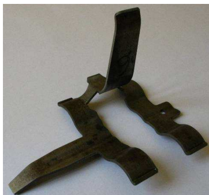
Rys. 3. Fotografia ogniwa po wygięciu części środkowej
