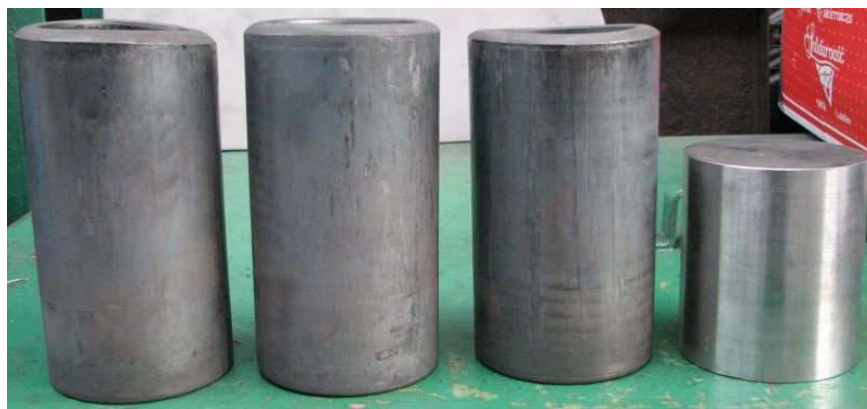
Rys. 1. Przykładowe wypraski i materiał wsadowy do prasowania na gorąco
