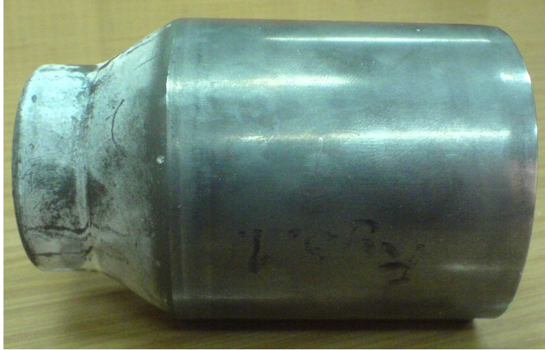
Rys. 2. Półfabrykat do zgniatania obrotowego na zimno (po dwóch operacjach wyciągania ścianki na zimno)
