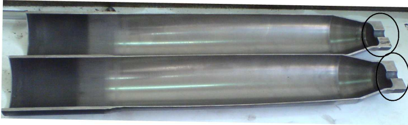
Rys. 5. Przekrój korpusu z zaznaczonym „pogrubionym” dnem po zgniataniu obrotowym na zimno
