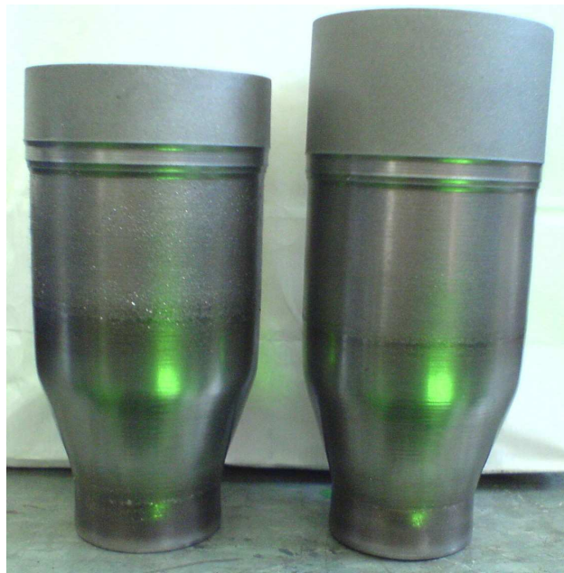
Rys. 3. Półfabrykaty po zgniataniu obrotowym na zimno w I przejściu
