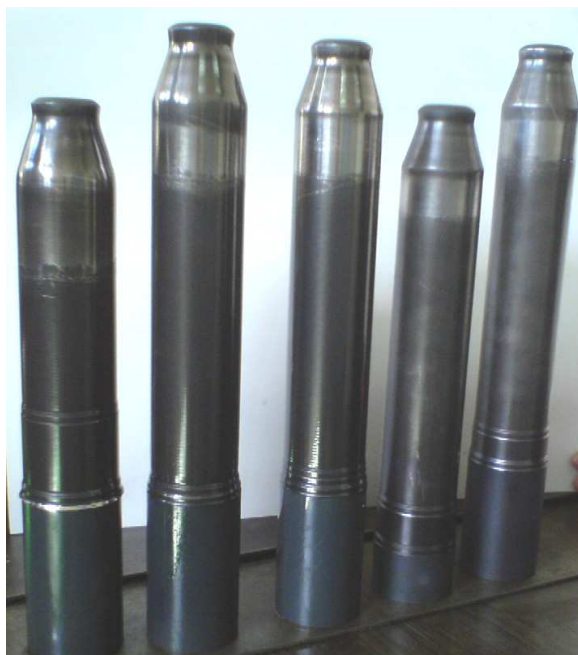
Rys. 4. Półfabrykaty po zgniataniu obrotowym na zimno w II przejściach
