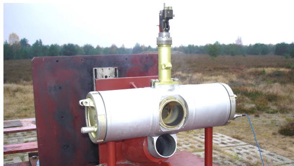
Rys. 6. Silnik raketowy fotela K36DM na poligonowym stanowisku do badań balistycznych
