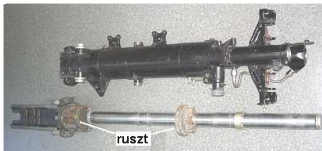
Rys. 3. Główne elementy silnika raketowego wymontowane z fotela katapultowego KM1M; korpus silnika (na górze), zespół dysz z dwoma perforowanymi rusztami, pomiędzy którymi umieszcza się ładunki prochowe (na dole)
