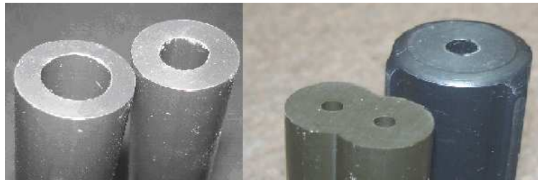
Rys. 2. Powierzchnie czołowe ładunków napędowych (od lewej): K4, K4M, PZAM, C
