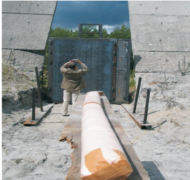
Rys. 2. Wydłużony ładunek saletrolu o masie 10 kg do generowania impulsu ciśnienia
