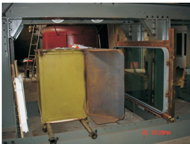
Rys. 5. Komora wybuchowa do wytwarzania impulsu ciśnienia z użyciem MPP
