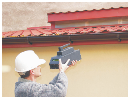
Fot. 2. Zdalny pomiar stężenia metanu w terenie
