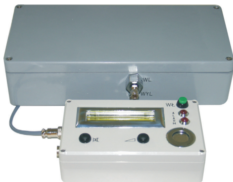
Fot. 3. Analizator spalin z blokiem czujników optoelektronicznych do oznaczania stężenia \text{SO}_2 , \text{NO}_x , \text{CO} , \text{CO}_2 , \text{HCl} , \text{HF} , \text{C}_n\text{H}_m
