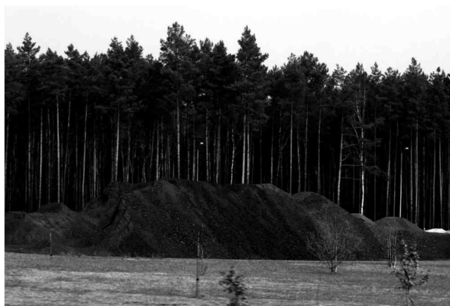
Rys. 6. Przykład tymczasowego składowania destruktu asfaltowego [źródło własne]
