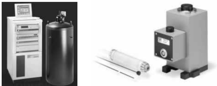
Rys. 10. Miernik własności fizycznych PPMS, wraz z osprzętem
