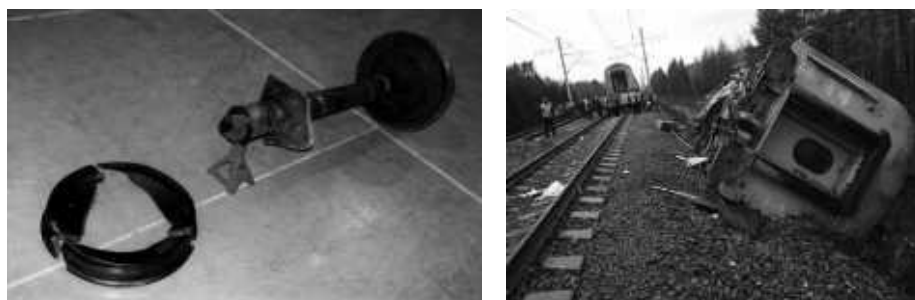
Rys. 1. Przykłady uszkodzeń zestawu kołowego
