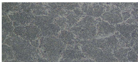
Rys. 4. Struktura metalograficzna stopiwa wykonanego elektrodą EB 1.50. Temp. łamania -40\text{ }^{\circ}\text{C} , pow. \times 200
