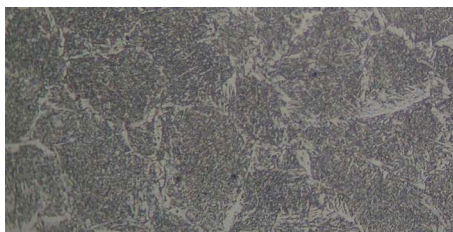
Rys. 5. Struktura metalograficzna stopiwa wykonanego elektrodą z dodatkiem niklu, temp. łamania-40°C, pow. x200
