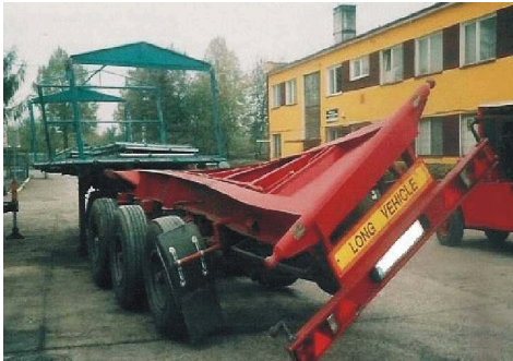
Rys. 1. Odkształcenie ramy naczepy samochodowej [13]
