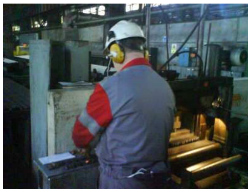
Rys. 1. Pomiary skuteczności działania nauszników przeciwhałasowych w warunkach rzeczywistych.
