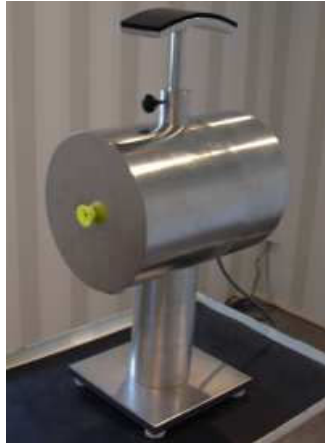
Rys. 5. Tester akustyczny stosowany do pomiarów tłumienia wtrącenia wkładek przeciwhałasowych.
