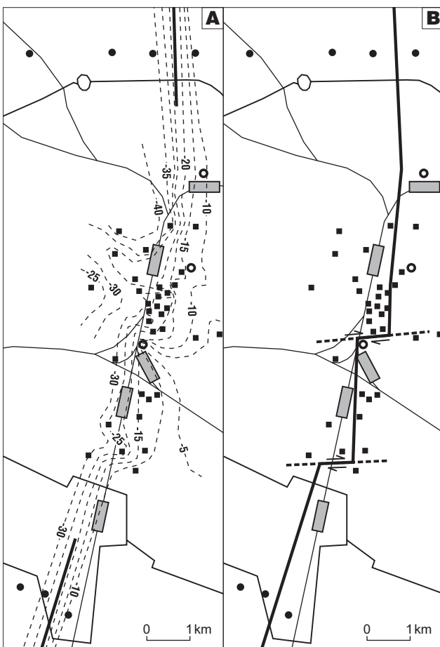
Ryc. 6. Główny wschodni uskoku rowu miasta Poznania wyznaczony na podstawie ukształtowania spągu ogniwa środkowopolskiego: A — uproszczona mapa strukturalna spągu ogniwa środkowopolskiego, B — lokalizacja wschodniego uskoku głównego rowu miasta Poznania (objaśnienia na ryc. 1 i ryc. 2) Fig. 6. Eastern major fault of the Poznań City Graben determined based on morphology of the Middle-Polish Member base: A — simplified structural map of the Middle-Polish Member base, B — location of the eastern major fault of the Poznań City Graben (explanations in Fig. 1 and Fig. 2)
