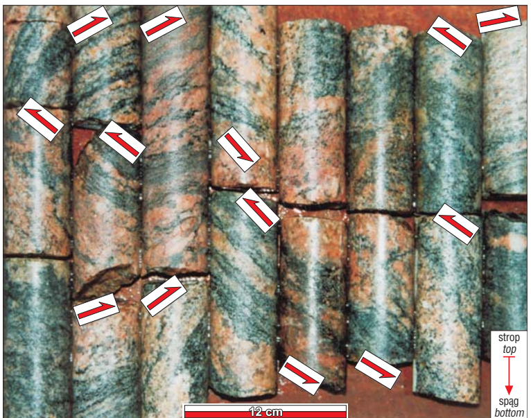
Ryc. 9. Przykłady gnejsów laminowanych, gnejsów oczkowych i granitów drobnokrystalicznych, słabo zdeformowanych. Stałe upady foliacji S_1 . Zwrot ścinania podatnego „strop” ku górze otworu (pojedyncze czerwone strzałki) wyznaczony przez typ \sigma porfiroklastów mikroklinu i plagioklazów oraz strukturę mylonityczną typu S-C. Przekroje rdzeni prawie równoległe do foliacji S_1 i prostopadłe do lineacji L_1 . Otwór Lazdijai 5. Próby rdzeni z głębokości od 468,0 do 498,7 m
