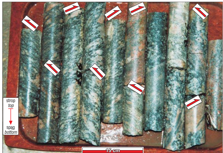
Ryc. 8. Heterogeniczny i zlokalizowany rozwój stref ścinania podatnego w monzodiorytach i granodiorytach kompleksu Veisiejai. Zwrot ścinania „strop” ku górze otworu (pojedyncze czerwone strzałki) wyznaczony przez struktury mylonityczne typu S-C oraz mikroklinowe porfiroklasty typu \sigma i rzadko typu \delta . Przekroje rdzeni równoległe do foliacji S_1 i prostopadłe do lineacji L_1 . Otwór Lazdijai 30. Próby rdzeni z głębokości od 631,2 (prawa strona fotografii) do 923,5 m (lewa strona fotografii)
