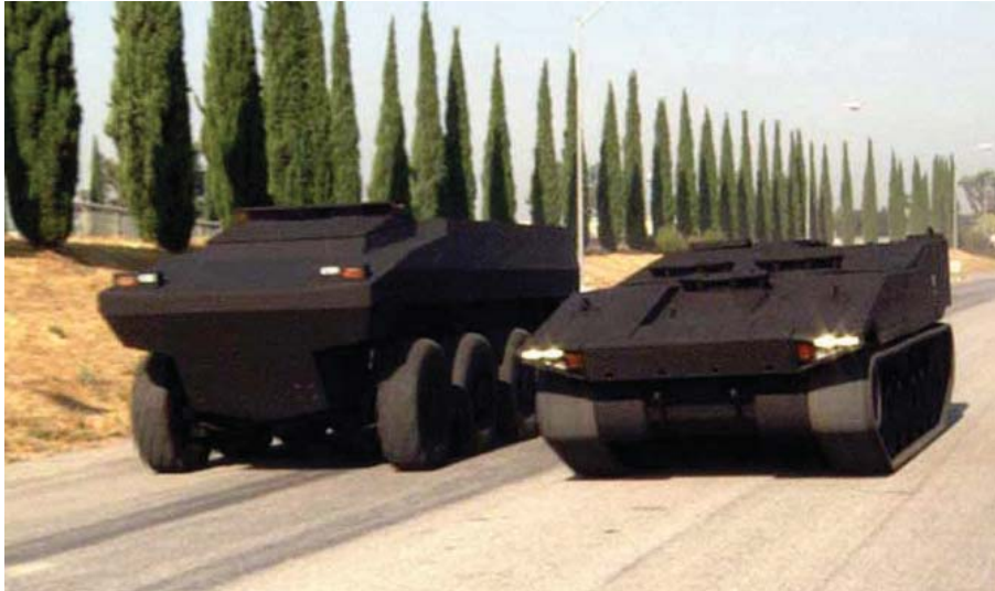
Rys. 1. Sylwetka pojazdu kołowego i gąsienicowego z podobnym nadwoziem Fig. 1. Profile of the wheeled and tracked vehicle with similar chassis
