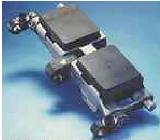
Rys.5. Ogniwo gąsienicy wozu bojowego firmy Diehl Fig. 5. Combat vehicle track produced by Diehl
