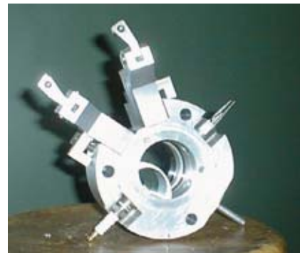
Rys. 2. Widok głowicy z komora wstępną Fig. 2. View of cylinder head with prechamber
