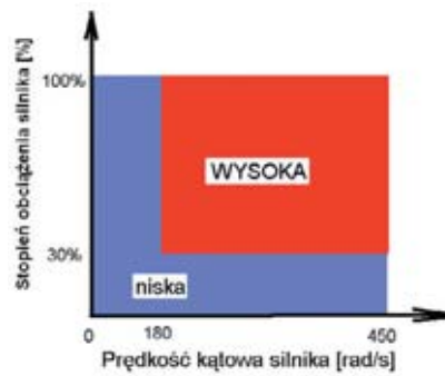
Rys. 5. Obszary niskiej i wysokiej emisji NO_x Fig. 5. Low and height NO_x emission areas
