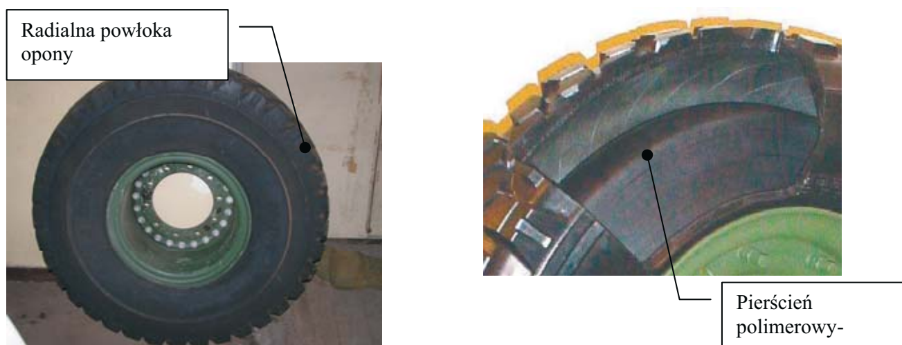
Rys. 1. Widok opony transportera opancerzonego z wkładką typu „run-flat” Fig. 1. A view of armored vehicle tire with „run-flat” insert
