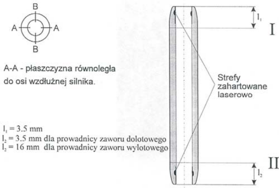
Rys. 6. Schemat prowadnicy zaworu z zaznaczonymi obszarami pomiarowymi oraz strefami zahartowanymi laserowo Fig. 6. Scheme of valve way with spotted measurement areas and laser hardened areas
