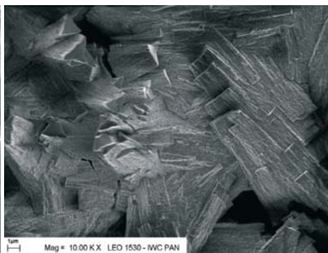
Rys. 2. Obraz SEM powierzchni aktywnej reaktora o zawartości platyny 1,5g na dm^3 Fig. 2. SEM picture of the catalytic active surface of catalyst with platinum content 1,5g for dm^3
