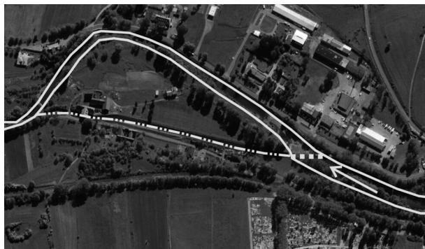
Ryc. 2. Przebieg koryta głównego Nysy Kłodzkiej i sztucznego kanału doprowadzającego wodę do elektrowni w Bystrzycy Kłodzkiej
