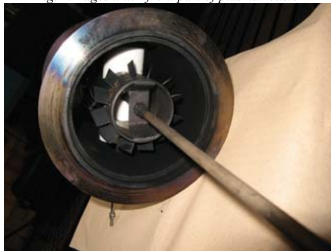
Rys. 3. Łopatki zawirowujące (zastrzone) i elektroda odchylająca - część tylna reaktora plazmowego Fig. 3. Swirling blades (sharpened) and deflective electrode - rear of plasma reactor
