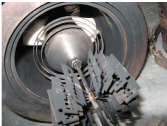
Rys. 2. Zespół ostrzy – część przednia reaktora plazmowego Fig. 2. Edges unit - front part of plasma reactor
