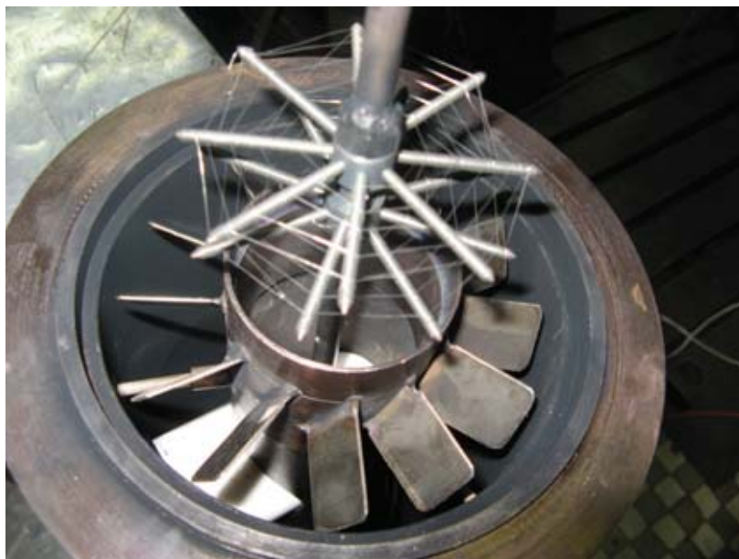
Rys. 6. Wariant II – zmodyfikowane łopatki zawirowujące i siatka cienkich drutów generujących wyładowania koronowe
