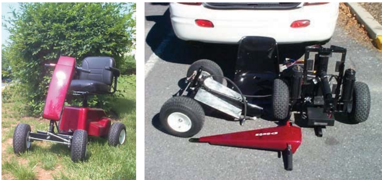
Rys. 3. Wózek golfowy Ramzes R-1, a) zmontowany, b) rozmontowany Fig. 3. Golf trolley Ramses R-1, a) mounted, b) dismantled
