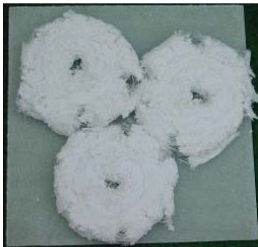
Rys. 17. Sposób niszczenia panelu energochłonnego w postaci trzech tulejek kompozytowych Fig. 17. Failure mode of an energy absorbing panel in a shape of three composite sleeves
