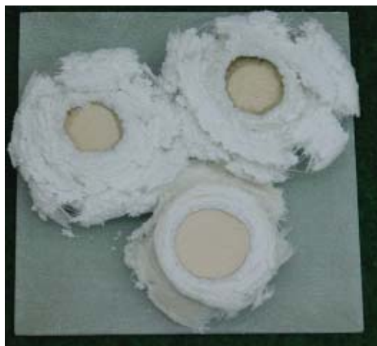
Rys. 20. Sposób niszczenia panelu energochłonnego w postaci trzech tulejek kompozytowych z wypełnieniem pianowym
