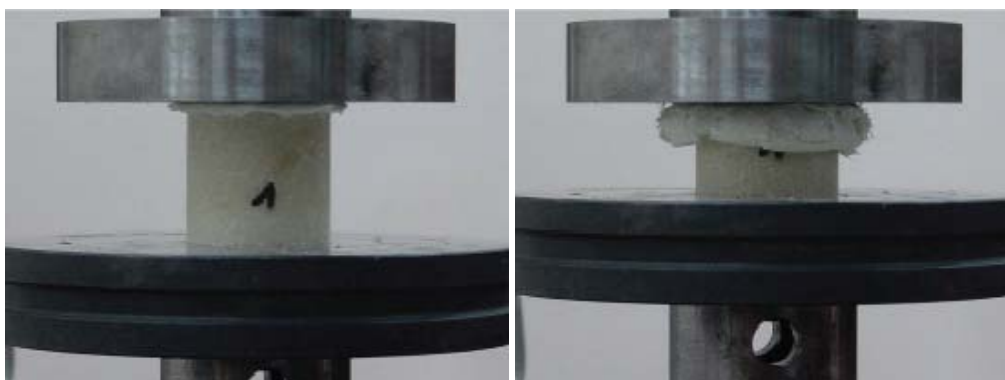
Rys. 8. Sposób niszczenia tulejki kompozytowej Fig. 8. Failure mode of the composite sleeve
