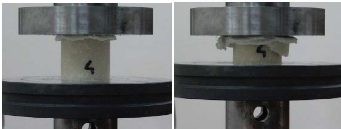
Rys. 13. Sposób deformacji tulejki kompozytowej z wypełnieniem pianowym Fig. 13. Deformation mode of the numerical model of the composite sleeve with a polymer fill
