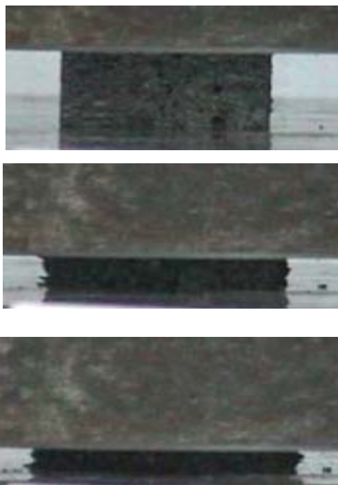
Rys. 6. Sposób niszczenia pierwszej próbki wykonanej z pianki metalicznej AK9/SiC (małe pęcherze) Fig. 6. Failure mode for the metallic foam AK9 / SiC specimen No. 1 (small blisters)
