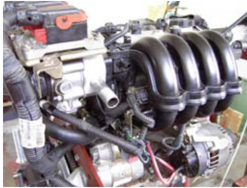
Rys. 5. Zmodyfikowany układ dolotowy Fig. 5. Modified intake system
