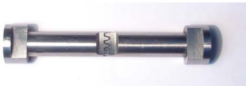
Rys. 3. Zespół dwóch tłoczników urządzenia do tłoczenia elementów sprężystych typu Hastings Fig.3. Set of two elements for forming device of springy Hastings ring
